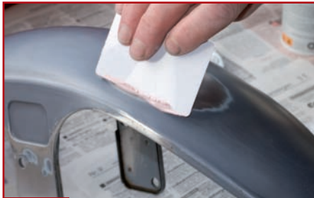
4. Spachtelmasse auftragen und glattschleifen...
