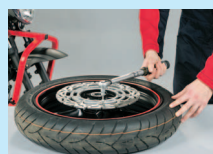
5. Neue Bremsscheibe aufsetzen und Befestigungsschrauben festziehen.
