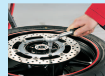
3. Befestigungsschrauben der Bremsscheibe lösen.
