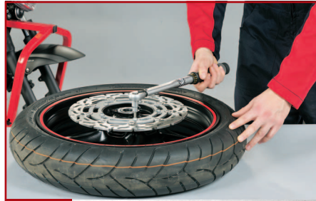
5. Neue Bremsscheibe aufsetzen und befestigen
