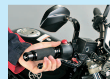
6. Druckpunkt der Bremse und Freigängigkeit des Rades überprüfen. Bremsscheibe reinigen.
