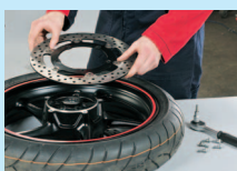
4. Alte Bremsscheibe abnehmen und Auflagefläche reinigen.
