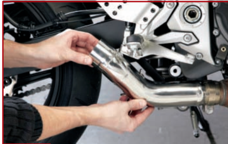
4. Zwischenrohr einschieben und Krümmerschelle vormontieren
