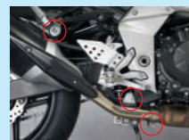
1. Lösen der Schrauben an Krümmerschelle, des Halters vom Endschalldämpfer und am Rahmen
