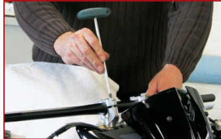
5. Montage neuer Klemmböcke, Ausrichtung des Lenkers
