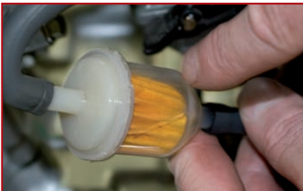
10. Luftblase im Benzinfilter? Knick im Benzinschlauch?
