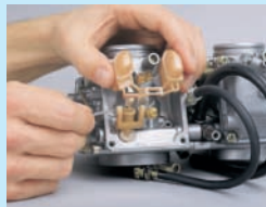
6. Achse herausziehen und Schwimmer entfernen.
