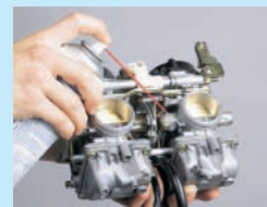
13. Alle drehbaren Teile neu einfetten.
