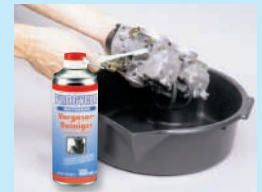
4. Vergaser äußerlich reinigen.
