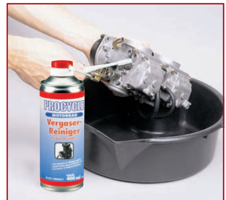
4. Vergaser äußerlich reinigen
